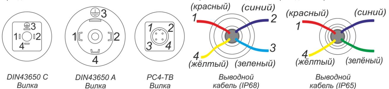
Рис. 1 Расположение контактов при электрическом присоединения датчиков
